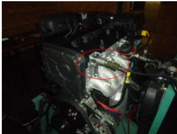
Figura 30: Posición del Acelerómetro uniaxial. Fuente: Los Autores.
