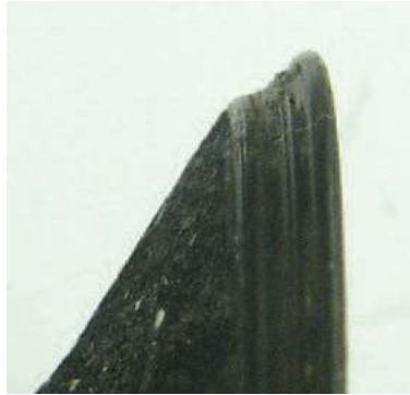
Figura 8: Desgaste en la región del asiento. Fuente: [10] (MAHLE, 2012, pág. 62)
