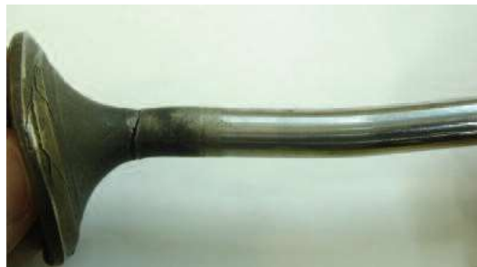
Figura 9: Válvula deformada y quebrada en la región del radio y vástago. Fuente: [10] (MAHLE, 2012, pág. 63)
