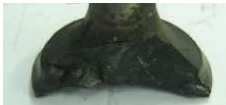
Figura 12: Rotura parte de la cabeza. Fuente: [10] (MAHLE, 2012, pág. 65)
