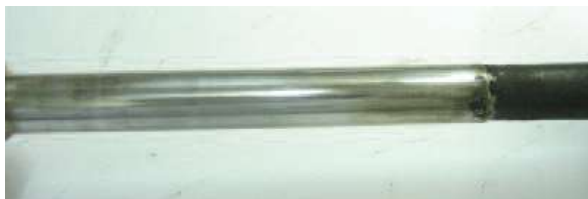
Figura 7: Gripaje en la región inferior de la válvula. Fuente: [10] (MAHLE, 2012, pág. 62)
