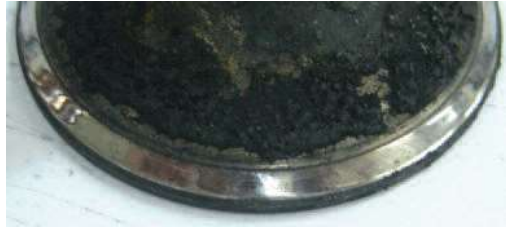
Figura 13: Desgaste en la región de la cabeza de la válvula. Fuente: [10] (MAHLE, 2012, pág. 65)
