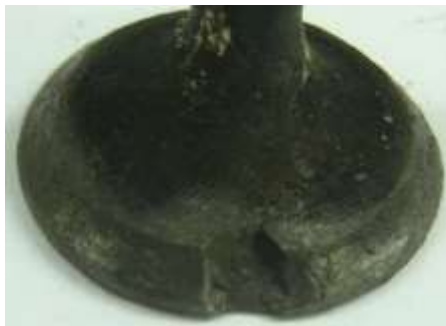
Figura 14: Desintegración localizada en la región del asiento de la válvula. Fuente: [10] (MAHLE, 2012, pág. 66)
