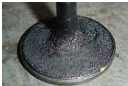
Figura 16: Válvula de admisión contaminada con aceite lubricante debido a holgura excesiva entre vástago y guía. Fuente: [10] (MAHLE, 2012, pág. 66)
