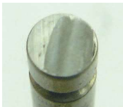
Figura 17: Marcas que indican que la válvula no giro. Fuente: [10] (MAHLE, 2012, pág. 66)
