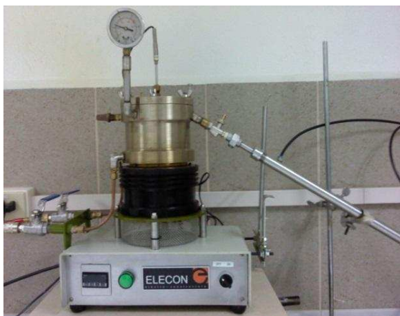
Figura 1. Reactor de Pirólisis utilizado en esta investigación
