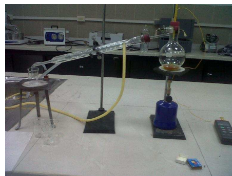
Figura 2. Sistema de destilación utilizado en esta investigación
