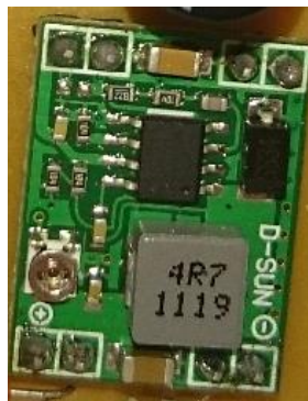
Figura 28 Regulador convertidor DC - DC
