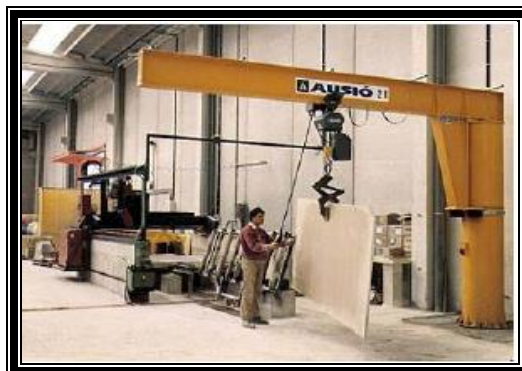
Figura 22. Grúa giratoria de columna fija con sistema de dos rodamientos
