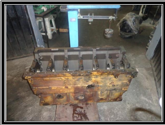
Figura 25. motor caterpillar 3306 diesel 10.500 cilindraje , peso 532,5lbs.
