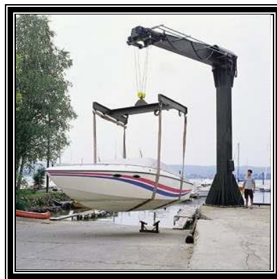
Figura 23. Grúa giratoria de columna fija de un rodamiento.
