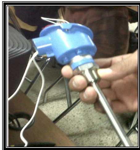
Figura 16. Sensor de temperatura pt100
