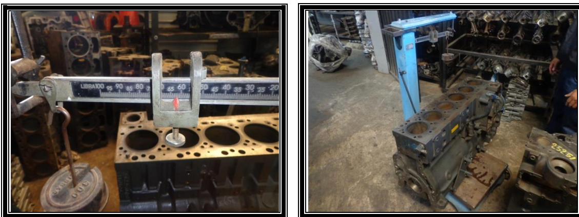
Figura 24. Motor komatsu 6.600cilindraje, peso 364lbs
