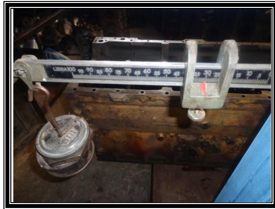
Figura 25. motor caterpillar 3306 diesel 10.500 cilindraje , peso 532,5lbs.
