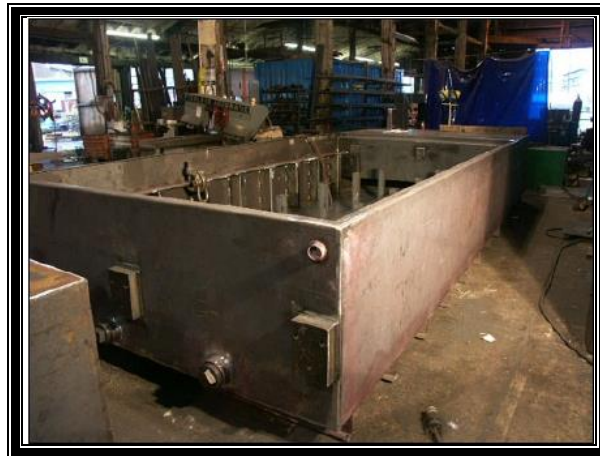
Figura 9. Tanque en construcción
