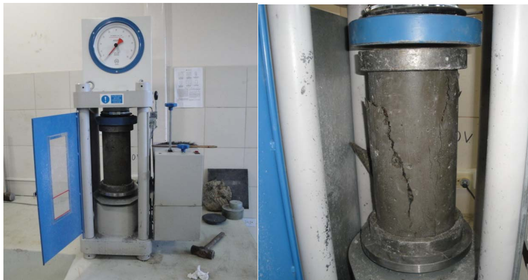
FOTOGRAFÍA 9.17.- Ensayo de Compresión de Cilindros (Diseño Teórico)
