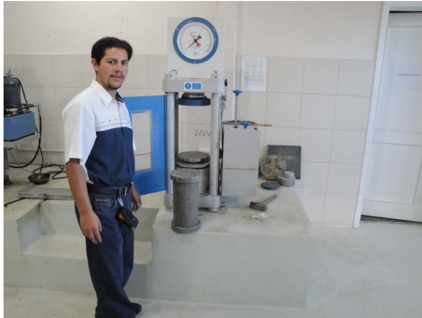
FOTOGRAFÍA 9.11.- Ensayo de Resistencia a la Compresión del Hormigón
