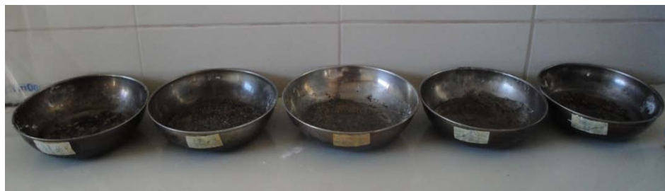
FOTOGRAFÍA 9.8.- Muestras para Ensayo de Resistencia a los Sulfatos
