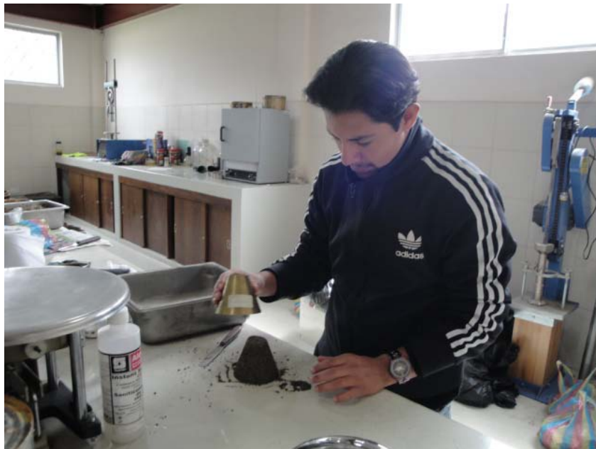
FOTOGRAFÍA 9.4.- Ensayo del Peso Específico del Agregado Fino
