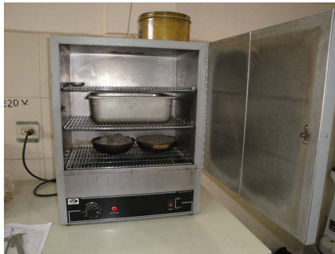
FOTOGRAFÍA 9.9.- Ensayo para Determinar el Contenido de Humedad de Los Agregados
