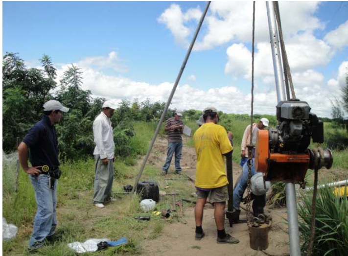
FOTOGRAFÍA 4.1.- Ensayo SPT (P - 1)
