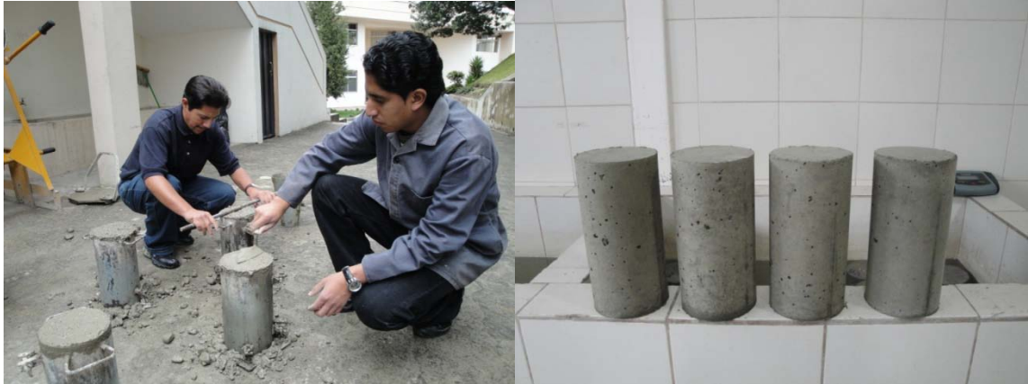
FOTOGRAFÍA 9.16.- Toma de Probetas de Hormigón (Diseño Teórico)
