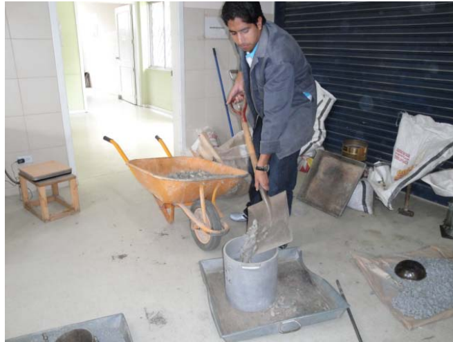
FOTOGRAFÍA 9.3.- Ensayo de Pesos Unitarios Suelos y Varillados
