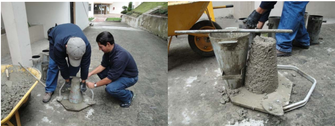
FOTOGRAFÍA 9.15.- Determinación del Asentamiento del Hormigón
