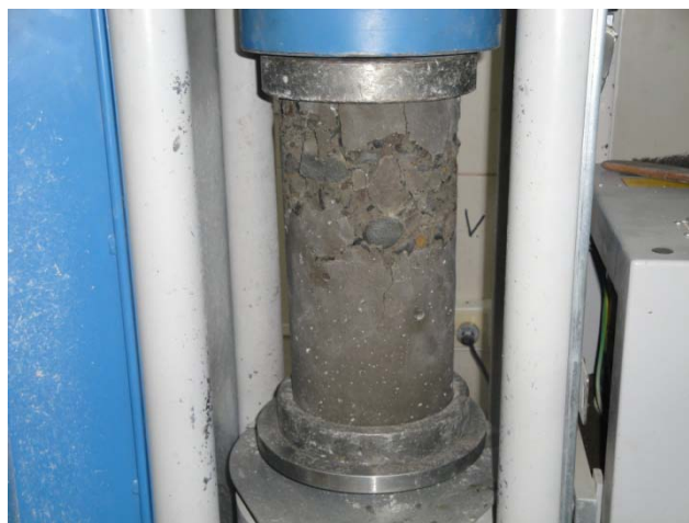
FOTOGRAFÍA 9.19.- Ensayo de Compresión de Cilindros (Diseño Definitivo)
