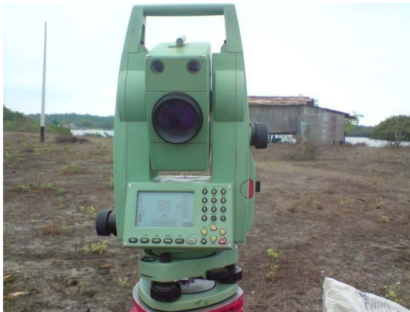
FOTOGRAFÍA 5.1.- Estación Total utilizada para el Levantamiento Topográfico
