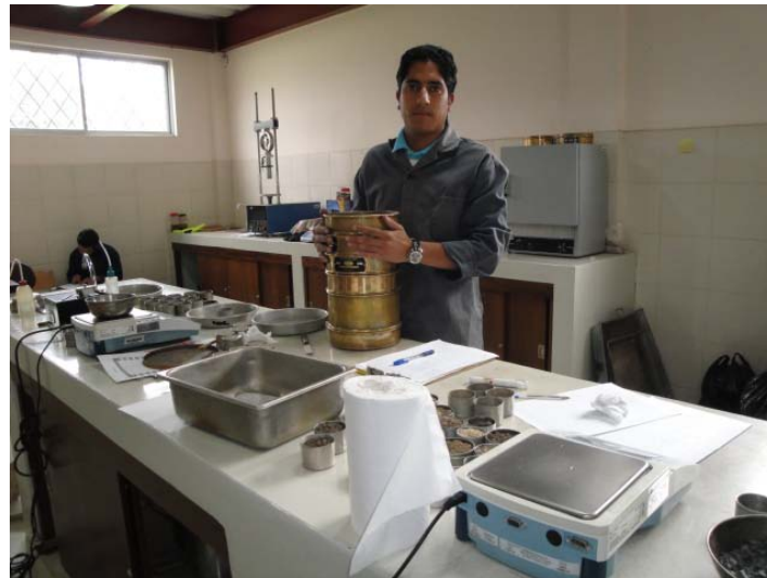
FOTOGRAFÍA 9.2.- Ensayo de Granulometría
