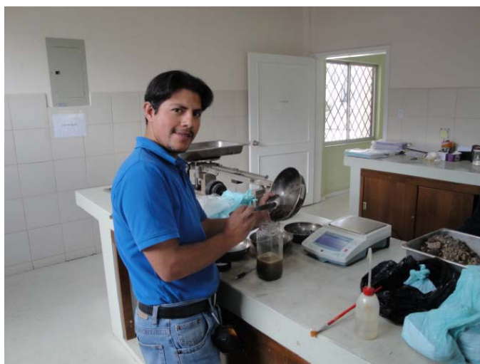
FOTOGRAFÍA 9.5.- Ensayo para Determinar las Impurezas Orgánicas en Arenas
