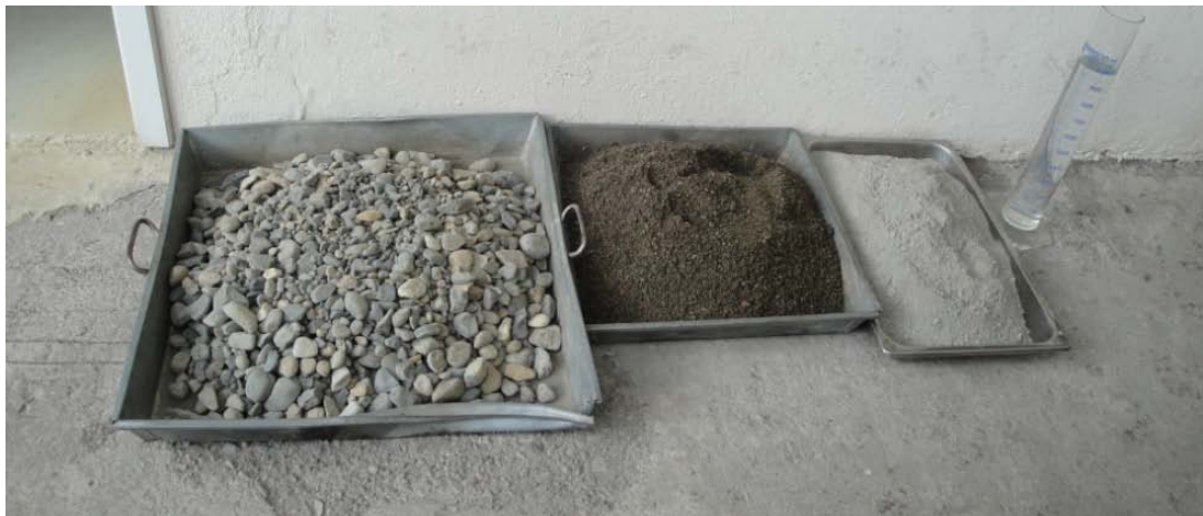
FOTOGRAFÍA 9.12.- Dosificación al Peso para 10 Kg. de Cemento
