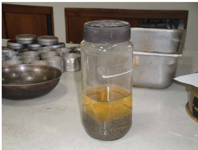
FOTOGRAFÍA 9.6.- Resultado de la Colorimetría Transcurrido las 24 Horas
