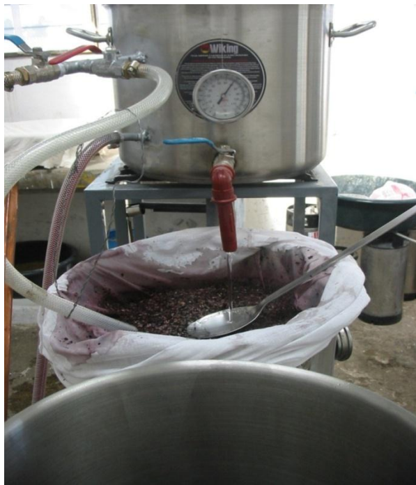
Fotografía 8. Sacarificación del almidón de maíz negro en prototipo semiautomático
