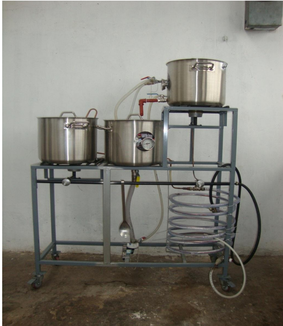
Fotografía 11. Prototipo semiautomático con intercambiador de calor y enfriador contracorriente
