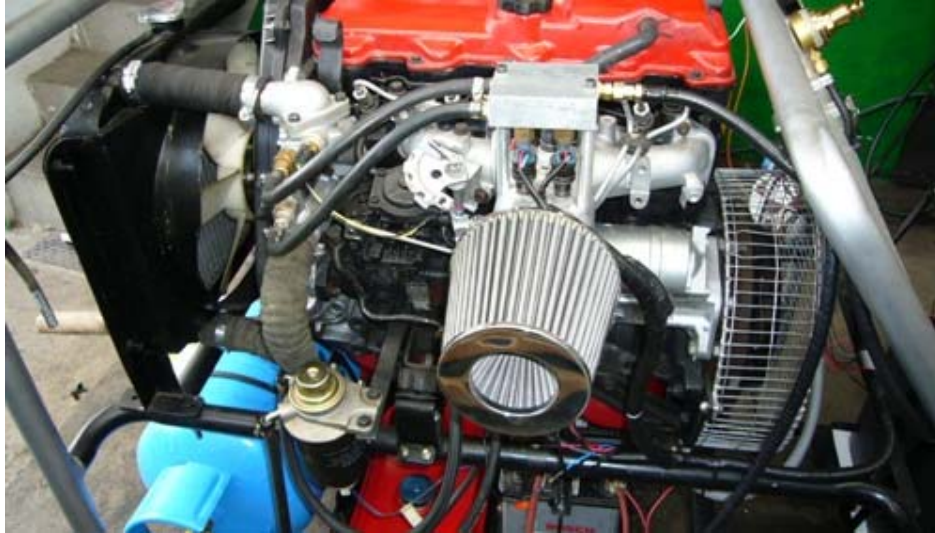
Figura 4.1 Instalacion del sistema GLP al motor Toyota 3L
