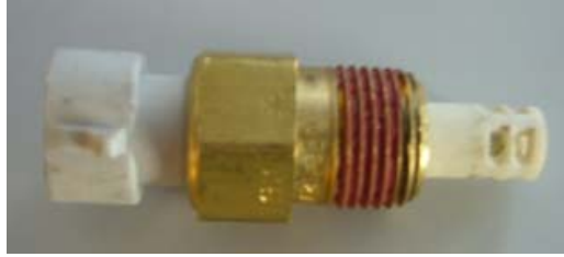
Fig 2.7 Sensor de temperatura del aire de admisión (IAT)
