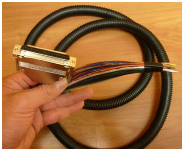
Fig 2.14 Cableado principal de conexión del ECM.
