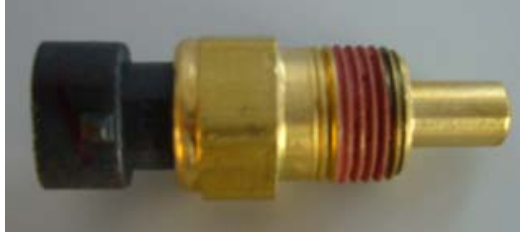
Fig 2.8 Sensor de temperatura del líquido refrigerante (ECT)
