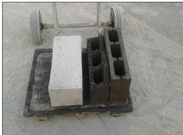
Figura 24. Secado de bloques al aire libre Elaborado por: Carolina Mejía
