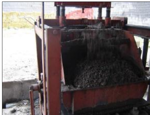
Máquina de vibrio – compactación
