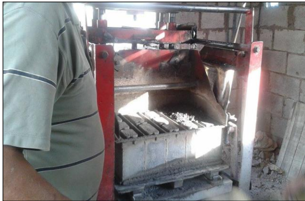
Figura 23. Desmolde de los bloques Elaborado por: Carolina Mejía
