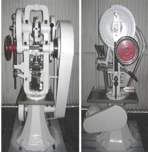
**Figura 15. Máquina de comprimir excéntrica MAP**
