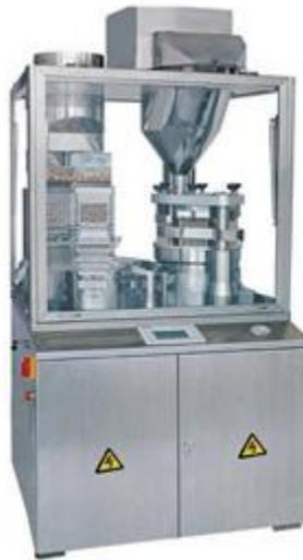
**Figura. 5 Máquina llenadora de cápsulas de gelatina dura**
