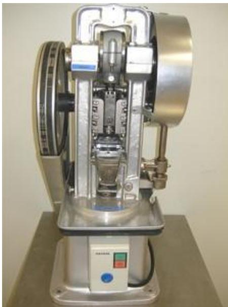
**Figura 14. Máquina de comprimir excéntrica MAP**
