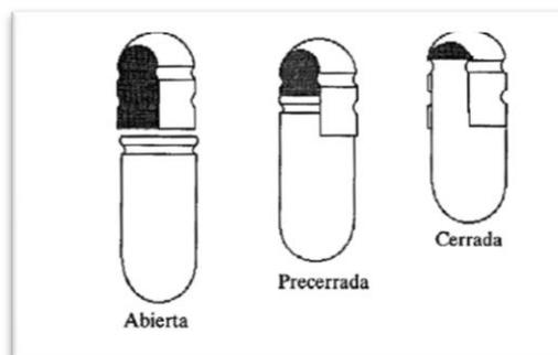
**Figura. 4 Sistema cani-snap, de cierre de cápsulas de gelatina dura**
