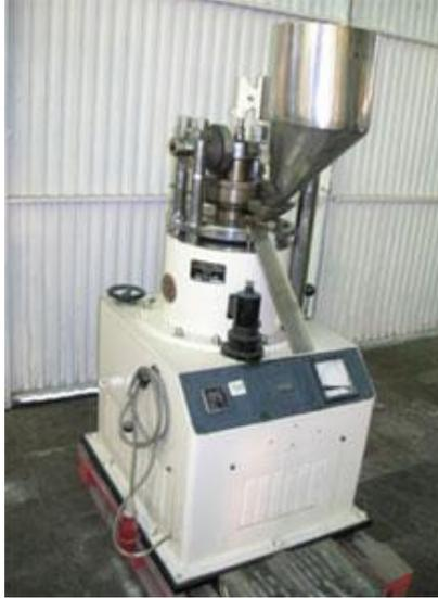
**Figura 16. Máquina de comprimir excéntrica MAP**
