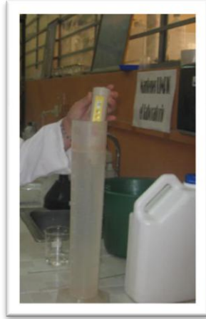
Foto 27. Medición de pH del agua filtrada (Fuente: las Autoras)
