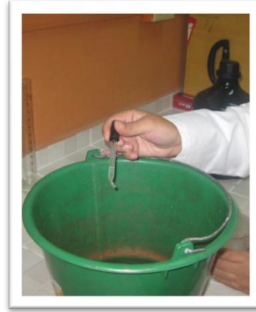
Foto 28. Reducción del pH a 3.5 con HCl. (Fuente: las Autoras)
