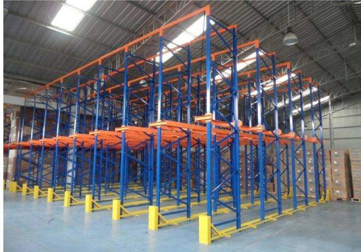
Fig. 2.4 Estanterías metálicas para carga pesada con recubrimiento de pintura en polvo
