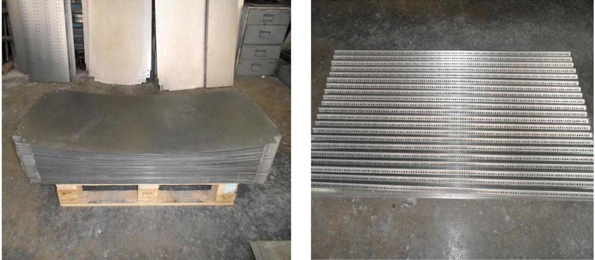
Fig. 2.2 Bandejas y parantes de tool previo al pretratamiento superficial de desengrase y fosfatado
