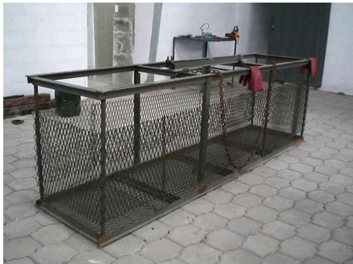
Fig. 2.9 Canasta para proceso de inmersión
