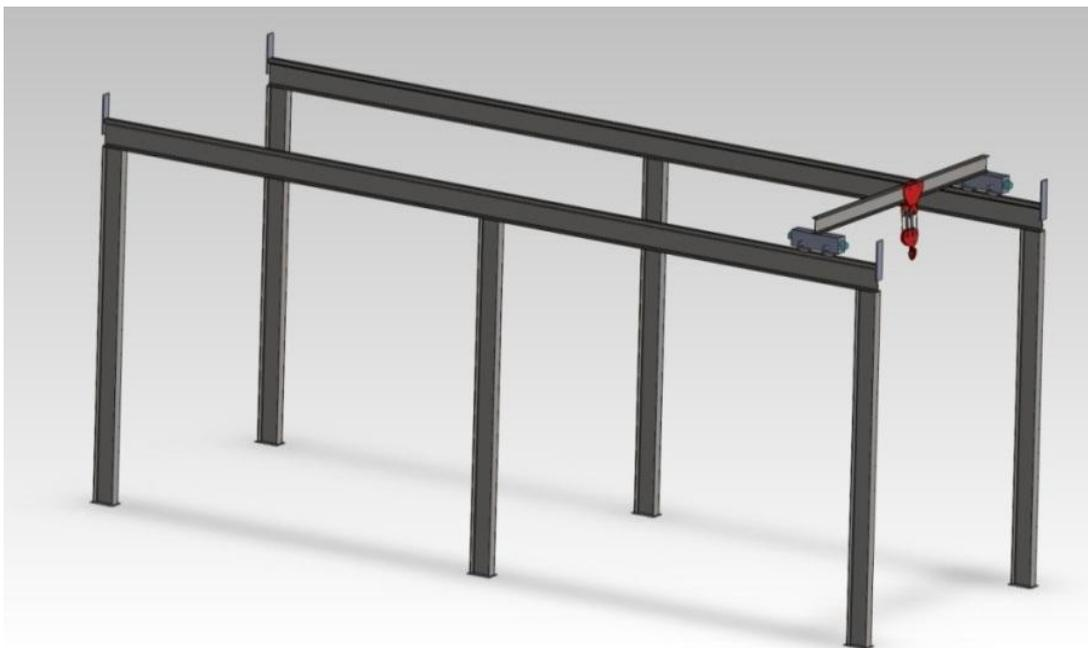
Fig. 4.26 Pórtico para transportar productos
