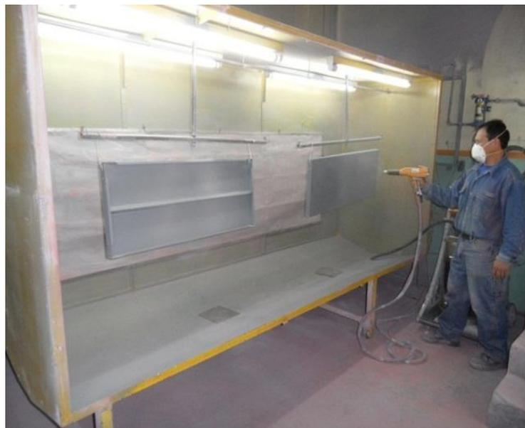
Fig. 1.5 Cabina para la aplicación de pintura en polvo.
