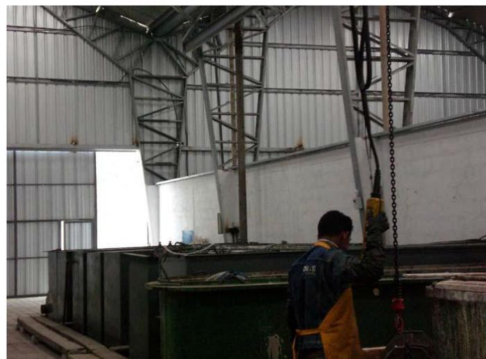
Fig. 2.11 Sistema de transportación por tren aéreo y polipasto
