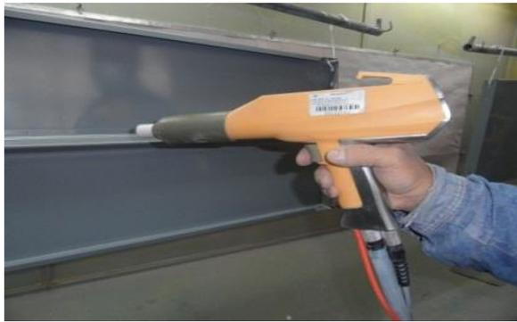
Fig. 1.3 Pistola para la aplicación del recubrimiento de pintura en polvo.
