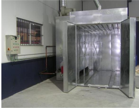
Fig. 2.13 Horno a gas por convección
