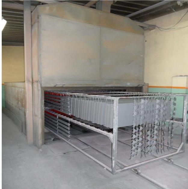
Fig.1.6 Horno por convección a gas para polimerizado de productos
