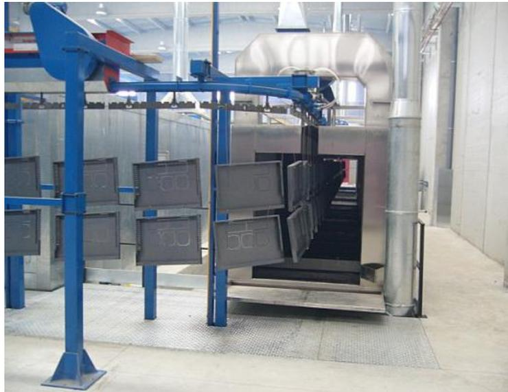
Fig. 1.9 Túnel de aspersión para limpieza de bandejas
