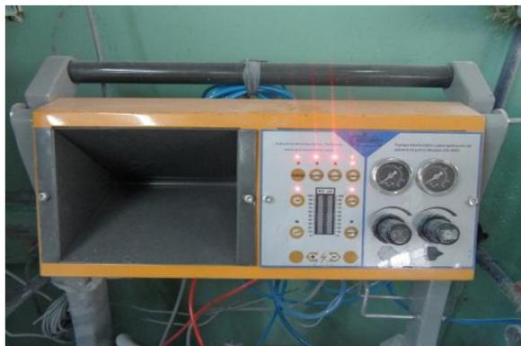
Fig.1.4 Panel de control, máquina para pintura electrostática
