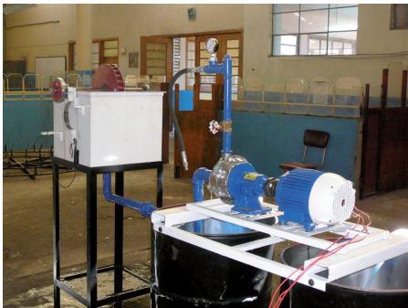
Figura. 6 a) (izq.) Banco de pruebas de ruedas hidráulicas b) Rueda hidráulica y su dispositivo de frenado
