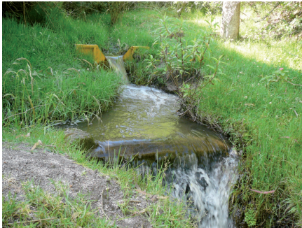
Figura 2. a) (izq.) Vertiente (Yumacay) b) (der.) Vertedero metálico colocado en la vertiente
