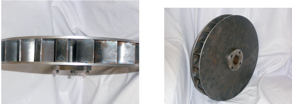
Figura. 5 Rueda Hidráulica Modelo (Diámetro 30 cm)
