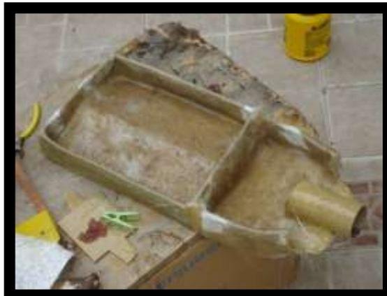
**Figura 51** Fabricación en cartón de la carcasa de la luminaria led
