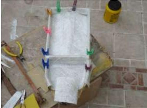
**Figura 52 Molde en resina de la carcasa de la luminaria led**
