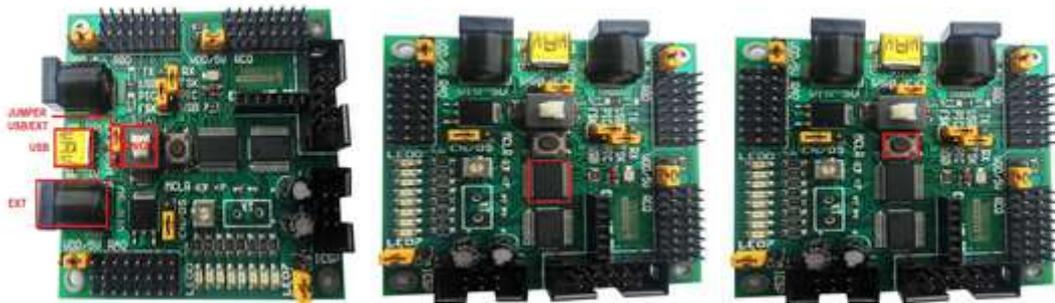
**Figura 13 Pic16f866 y fuente del Módulo de Entrenamiento (2012)**
