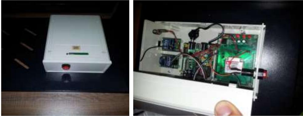
**Figura 73 Esquema del módulo GSM**
