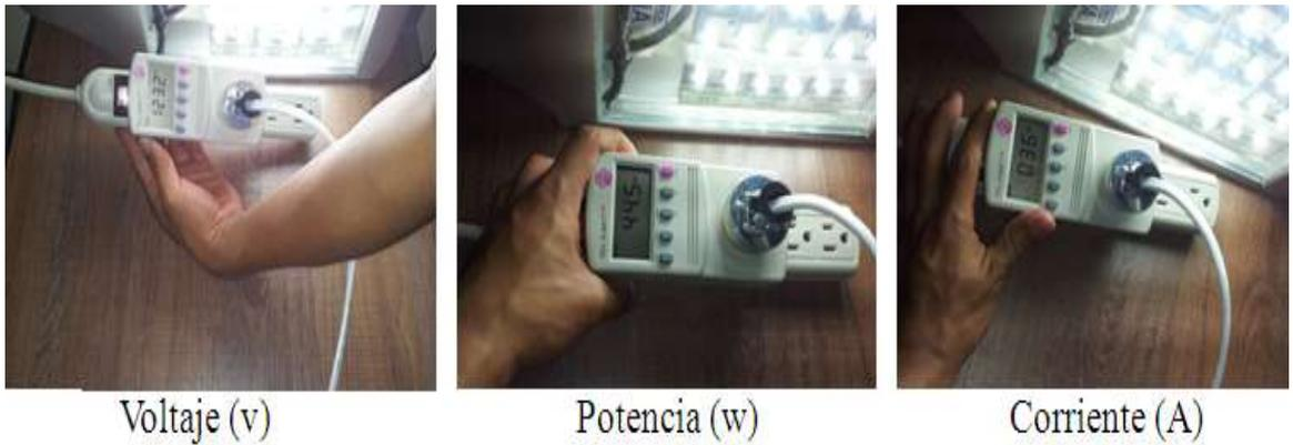
**Figura 85 Prueba de consumo de energía eléctrica sin dimerizador**
