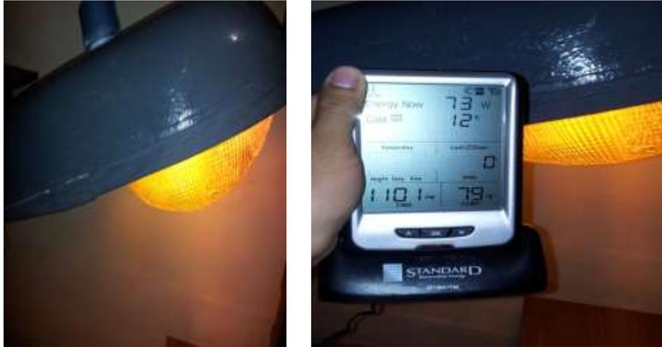
**Figura 88 Consumo de Energía eléctrica de Luminaria incandescente**
