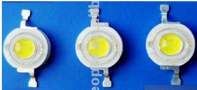
**Figura 11 Led de alta potencia en china, (1999)**
