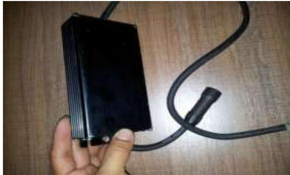
**Figura 61 Fuente de voltaje D.C.**
