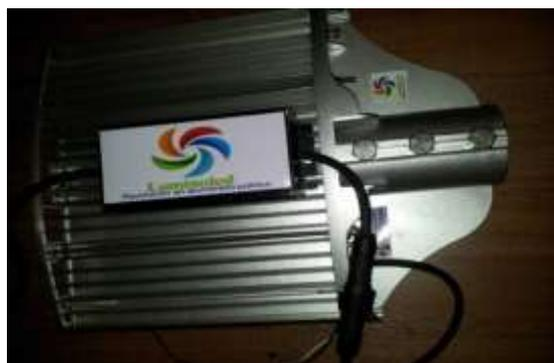
**Figura 63 Colocación de hologramas en la fuente de voltaje D.C. y carcasa de la luminaria led**
