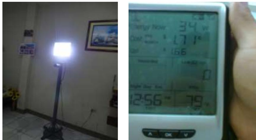
**Figura 87 Consumo de Energía Eléctrica de Luminaria Led.**
