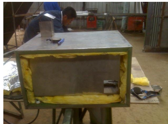
Instalación de aislamiento térmico (lana de vidrio) para la cámara de secado.
