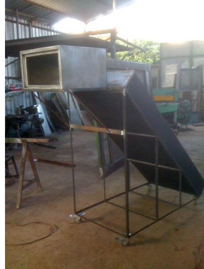
Adecuaciones en estructura del colector solar (colocación de llantas fijas y móviles), montaje de estructura portante para el deshidratador.
