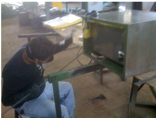
Instalación de aislamiento térmico (lana de vidrio) para la cámara de secado.
