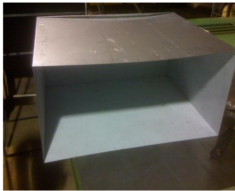
Construcción de la parte interna del deshidratador en acero inoxidable
