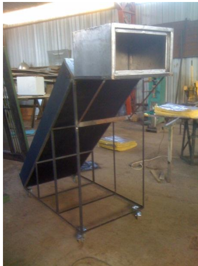
Adecuaciones en estructura del colector solar (colocación de llantas fijas y móviles), montaje de estructura portante para el deshidratador.
