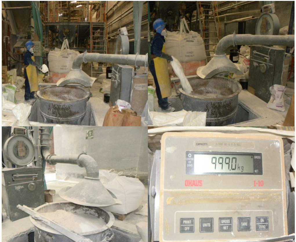
Ilustración 4 Proceso de dosificación y pesado de materia prima
