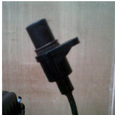
Figura 6. Sensor CKP Inductivo. Fuente: Los Autores
