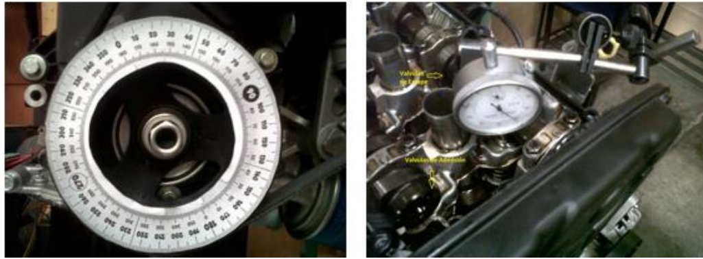
Figura 9. Montaje de plantilla graduador y reloj comparador. Fuente: Los Autores
