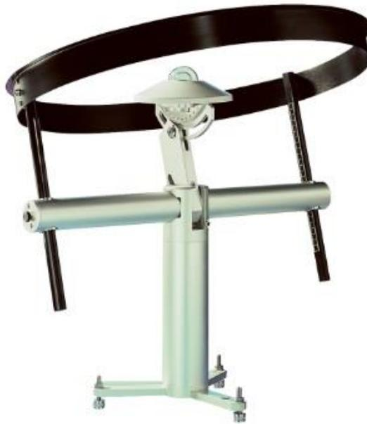
**Figura 1.14.** Piranómetro protegido (radiación difusa).
