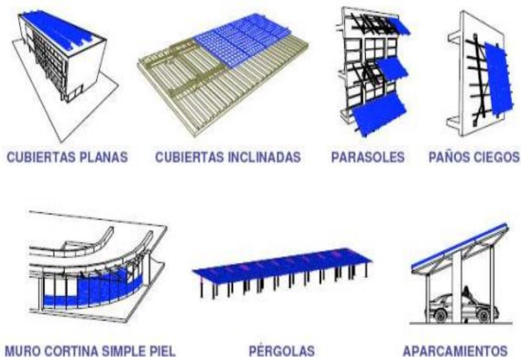
**Figura 1.21.** Sistema con integración arquitectónica en edificaciones.
