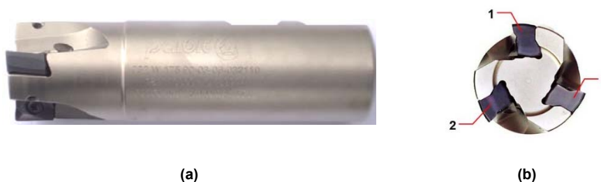
Figura 5.2 – Fresa utilizada nos ensaios: (a) vista lateral e (b) vista de topo
