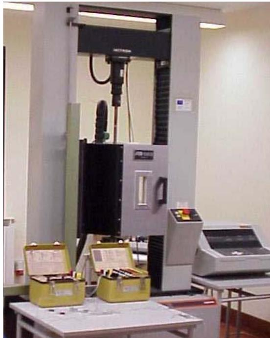
Figura 4.3 Máquina Instron modelo 4206 com câmara ambiental ATS.
