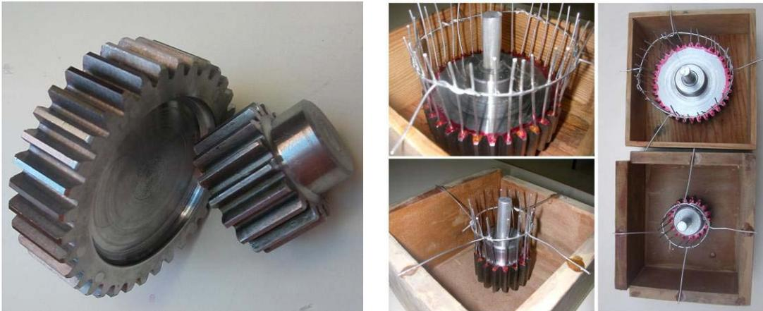
Figura 2.25 Imagens das rodas metálicas obtidas por fresagem e preparação dos modelos-ferramenta para definição do molde em silicone.
