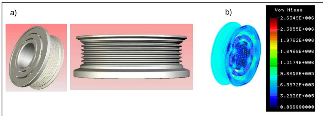
Figura 3.16 a) Modelo tridimensional da polia; b) Tensão equivalente Von Mises (para uma frequência de 6000 r/min).
