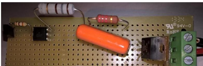
Figura 60 - Acionamento de motor de alimentação, em protótipo, através de opto-isolador com deteção de passagem por zero.
