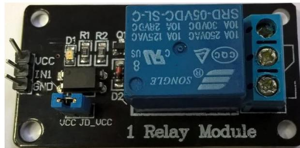
Figura 51 - Módulo de relé utilizado na comutação da resistência de aquecimento.
