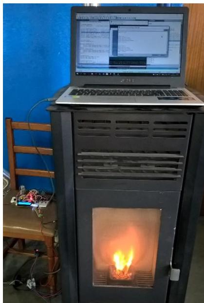
Figura 42 - Salamandra de testes, modelo Prima Air, durante um ensaio de queima.
