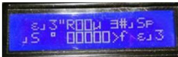
Figura 58 - Ecrã corrompido pela comutação do motor de alimentação.
