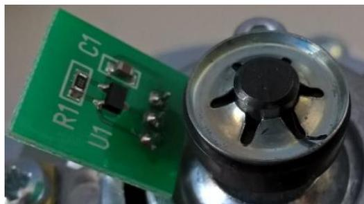
Figura 90 - Encoder de efeito de Hall do motor extrator de fumos.
