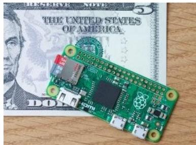
Figura 41 - Comparação do Raspberry Pi Zero com uma nota de 5\$ [50].
