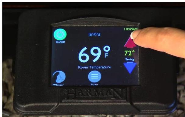
Figura 26 - Interface de ecrã-táctil para salamandra a pellets [39].
