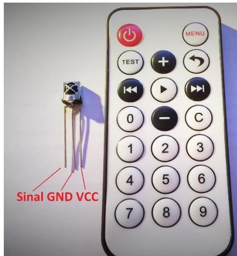
Figura 53 - Conjunto de comando remoto emissor e recetor de infravermelhos.
