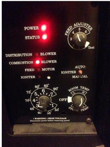
Figura 24 - Interface com potenciômetros para salamandra a pellets [37].
