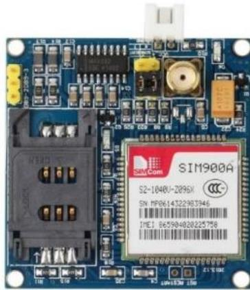
Figura 31 - Módulo GSM/GPRS [44].
