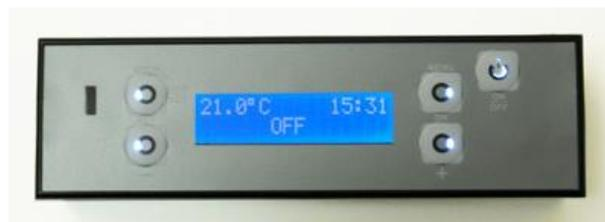
Figura 25 - Interface com LCD para salamandra a pellets [38].
