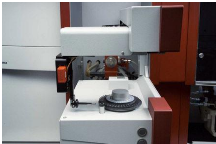
11. ábra Szilárdmintás HR-CS-GFAAS berendezés atomizáló és mintabevivő egysége [117]
