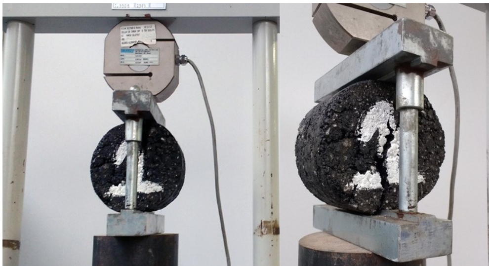
Figura 4.16 - Corpo de prova antes e depois da ruptura.
