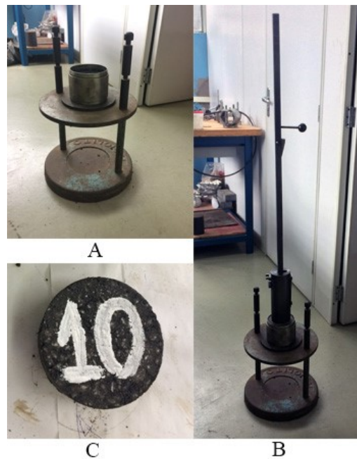
Figura 4.6 - Extração dos corpos de prova: (a) molde sobre o suporte extrator, (b) soquete Marshall auxiliando na extração e (c) corpo de prova extraído.
