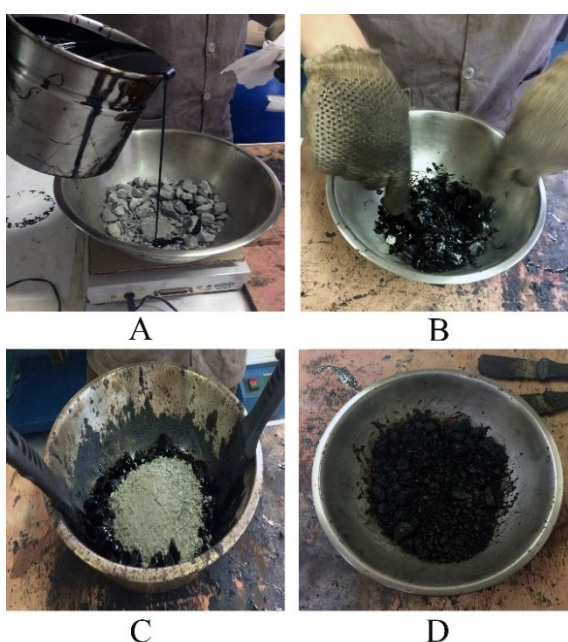
Figura 4.3 - Realização das misturas asfálticas: (a) adição do ligante aos agregados graúdos, (b) envolvimento total dos agregados graúdos, (c) colocação dos agregados finos e (d) mistura homogeneizada.
