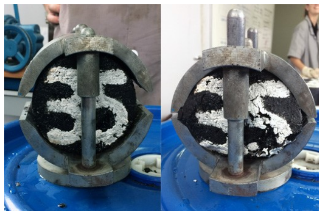
Figura 4.15 - Corpo de prova antes e depois da ruptura.
