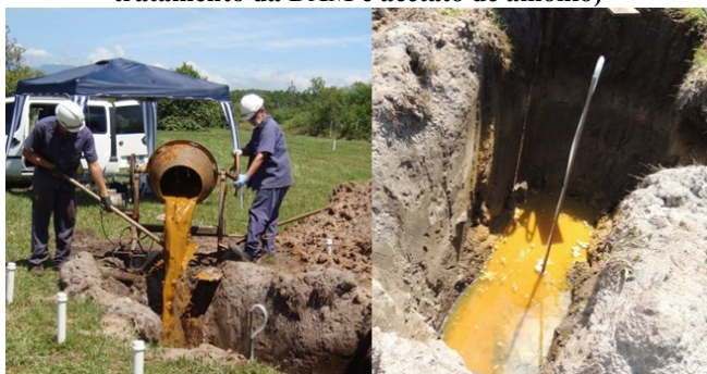
Figura 4.9: Adição dos produtos de remediação (produto recuperado do tratamento da DAM e acetato de amônio)
