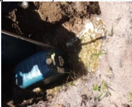
Figura 4.8: Liberação controlada do diesel B20
