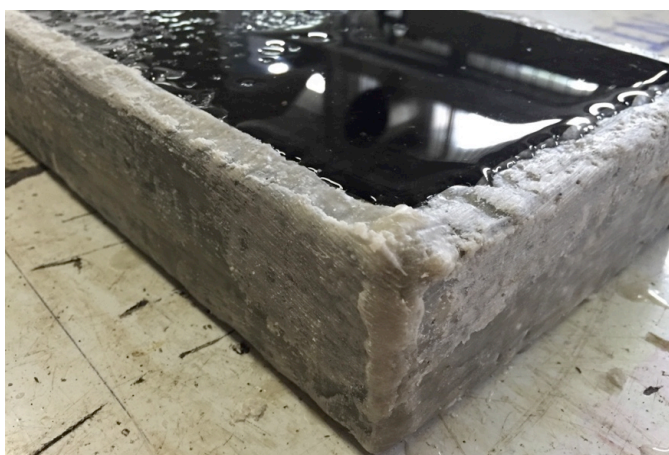
Figura 3.5 – Placa 2 durante ensaio de vazios comunicantes
