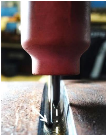
Figura 58. Alinhamento entre o eletrodo de tungstênio e o arame no interior do chanfro.
