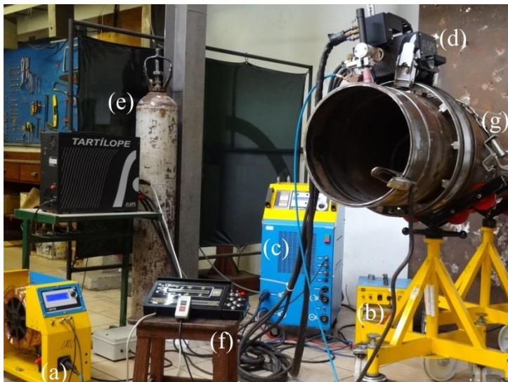
Figura 48. Bancada de ensaios de soldagem orbital: (a) Cabeçote alimentador de arame, (b) Unidade portátil de refrigeração, (c) Fonte de energia, (d) Manipulador robótico e Tocha TIG, (e) Cilindro de gás, (f) Controlador do cabeçote alimentador e IHM, (g) Corpo de prova.
