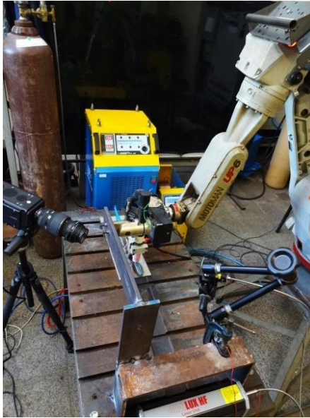
Figura 39. Configuração utilizada para monitoração com filmagem em alta velocidade durante a soldagem.
