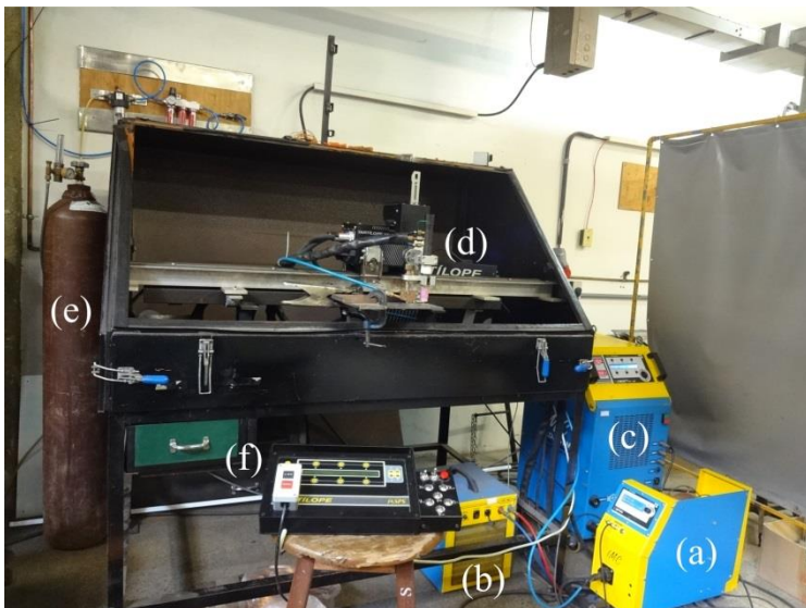
Figura 32. Bancada de ensaios: (a) cabeçote alimentador de arame, (b) unidade portátil de refrigeração, (c) fonte de energia, (d) manipulador robótico e tocha TIG, (e) cilindro de gás, (f) controlador do cabeçote alimentador e IHM.
