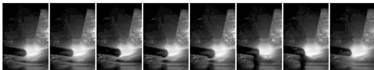
Figura 71. Filmagem em alta velocidade. Intervalo de 0,02 s entre as imagens analisadas. Ângulo de inserção do arame de 80^\circ . Processo com alimentação contínua.
