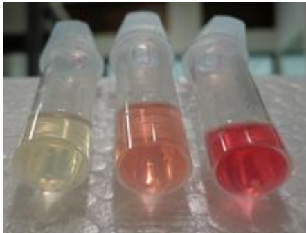
Figura 13: Foto dos três tipos de pigmentos que compõem o pigmento vermelho Monascus , que foram separados em coluna de sílica gel. Pigmentos: amarelo, laranja e vermelho.
