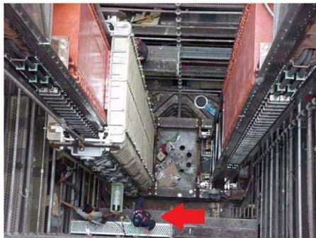
Figura 2.7 – Gerador linear de ímãs (MUELLER e POLINDER, 2013) (GARGOV, ZOBAA e TAYLOR, 2012).
