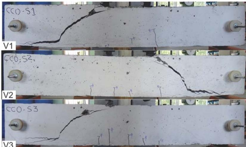
Figura 5.10: Vigas de concreto CC0 sem armadura transversal após ruptura.
