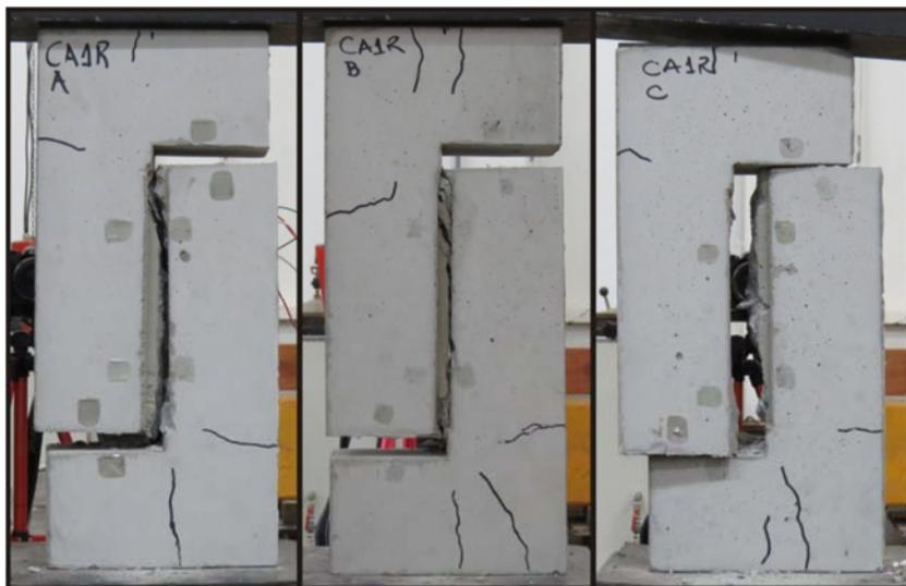
Figura 5.55: Exemplos de concreto CA1R após ruptura.
