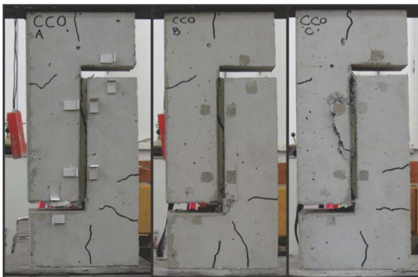
Figura 5.52: Exemplos de concreto CC0 após ruptura.
