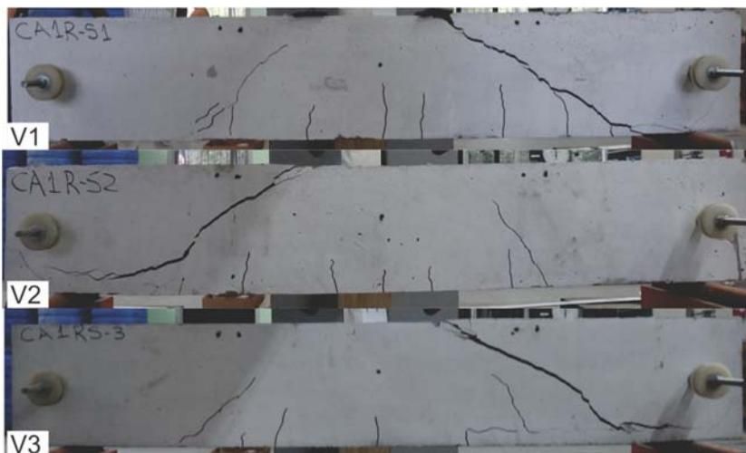
Figura 5.12: Vigas de concreto CA1R sem armadura transversal após ruptura.
