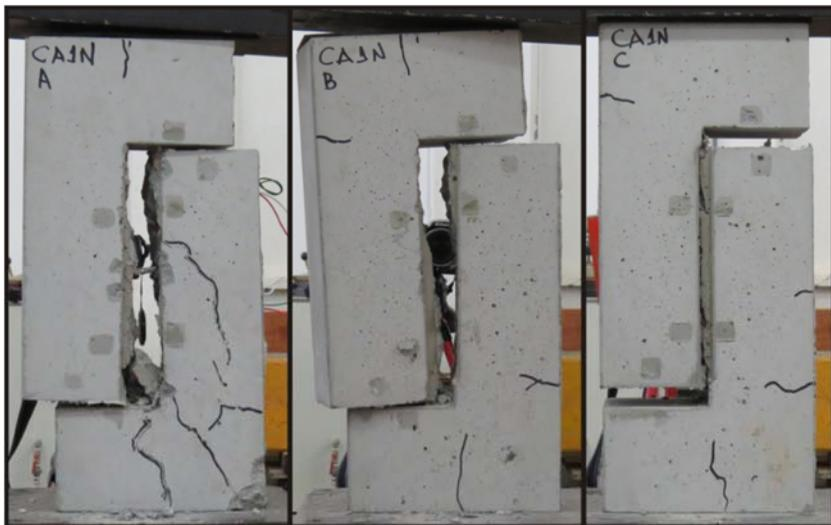
Figura 5.53: Exemplos de concreto CA3N após ruptura.
