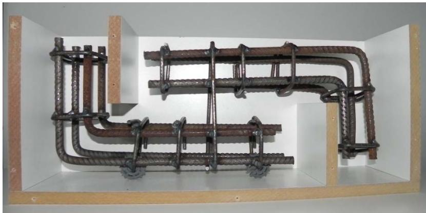
Figura 5.6: Forma com armadura dos exemplares dos ensaios de cisalhamento direto.
