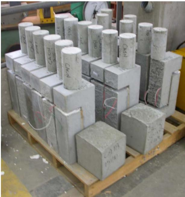
Figura 5.7: Exemplos de cisalhamento direto e corpos-de-prova cilíndricos.
