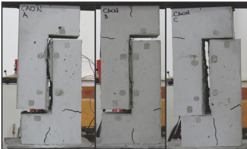
Figura 5.54: Exemplos de concreto CA0N após ruptura.
