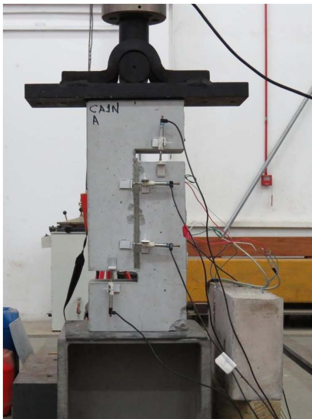
Figura 5.8: Montagem do ensaio de cisalhamento direto.
