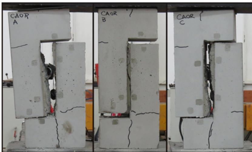
Figura 5.56: Exemplos de concreto CA0R após ruptura.
