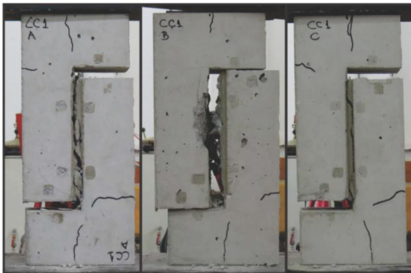
Figura 5.51: Exemplos de concreto CC1 após ruptura.
