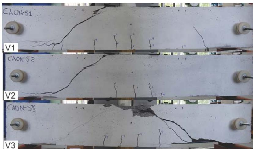
Figura 5.13: Vigas de concreto CA0N sem armadura transversal após ruptura.
