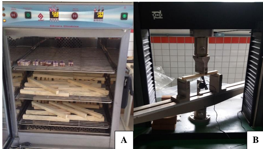
Figura 6 — Corpos de prova em condicionamento no interior da Câmara climática (A); Ensaio de flexão estática em máquina universal de ensaios mecânicos (B).
