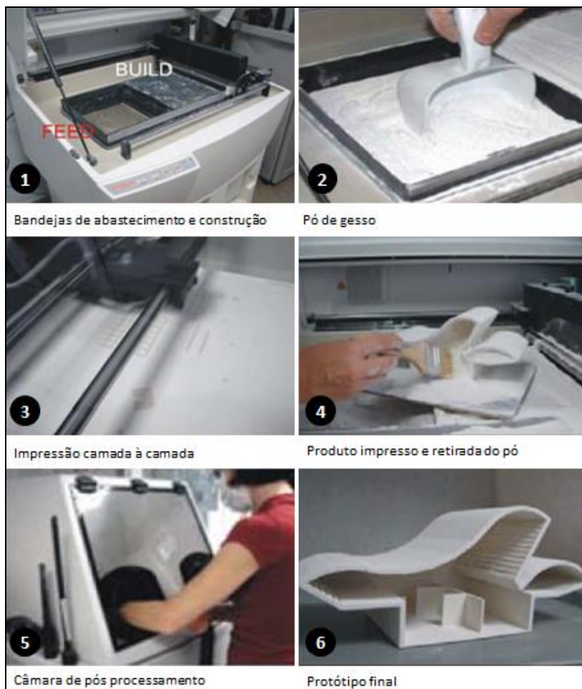
Figura 1 - Esquema de impressão 3D baseada em pó
