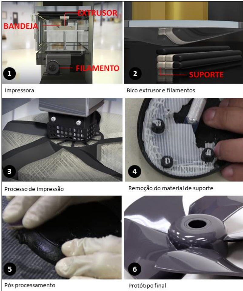
Figura 4 - Esquema de impressão fused deposition modeling
