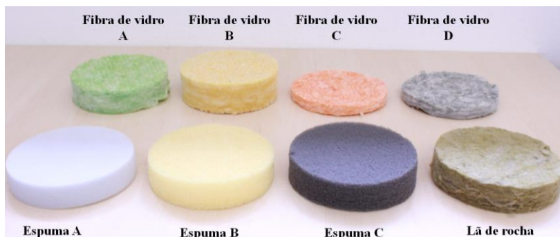
Figura 20: Amostras de 107 mm de diâmetro usadas na caracterização inversa.
