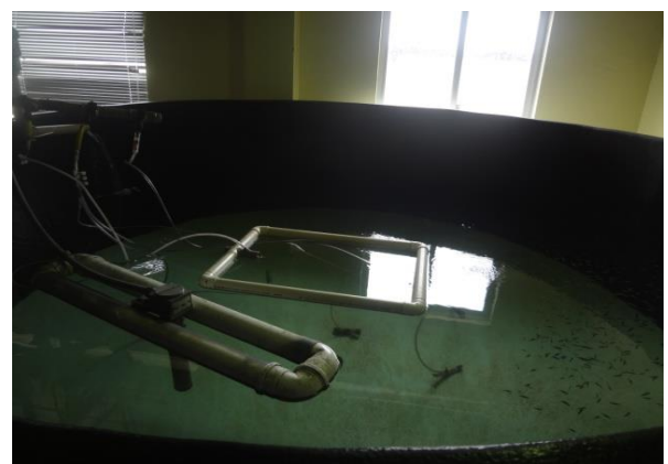
Figura 7: Sistema de aeração e aquecimento
