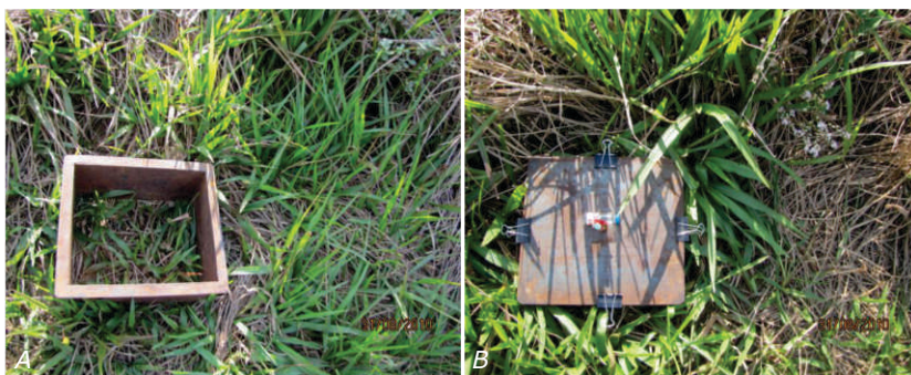
Figura 12.2. Material utilizado para coleta de amostras de N_2O . Comperj, Itaboraí, 2010.
