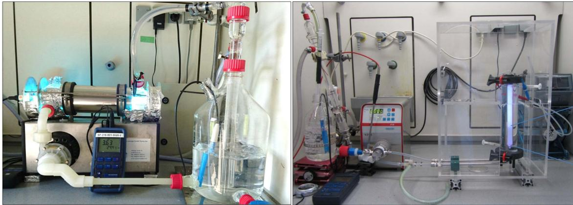
Abbildung 1: Versuchsaufbau zum Abbau von Antibiotika (hier: Sulfamethoxazol). Links klassischer UVC Strahler, rechts Phosphorkonvertierte Xenon-Entladungslampen.
