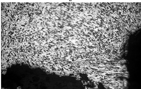
Рис. 5. Характер зламів зразків на ударну в'язкість металу аноду після 10-ти років експлуатації (а) і лінія злому зразка (б, \times 100 )
