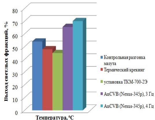
Рис. 2. Вихід светлих нефтепродуктів при різних технологіях крекинга
