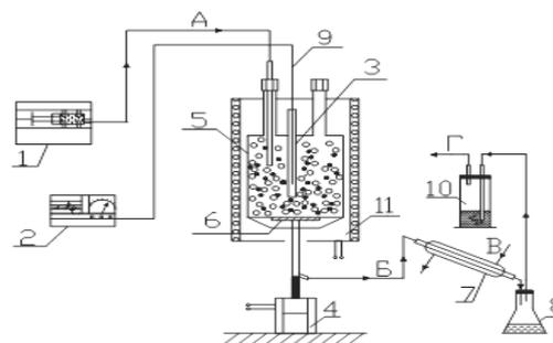
Рис. 1 Схема лабораторной установки процесса крекинга мазута с применением технологии аэрозольного нанокатализа.
