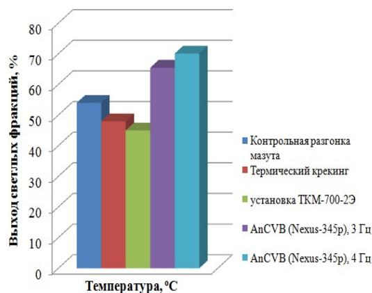
Рис. 2. Выход светлых нефтепродуктов при различных технологиях крекинга
