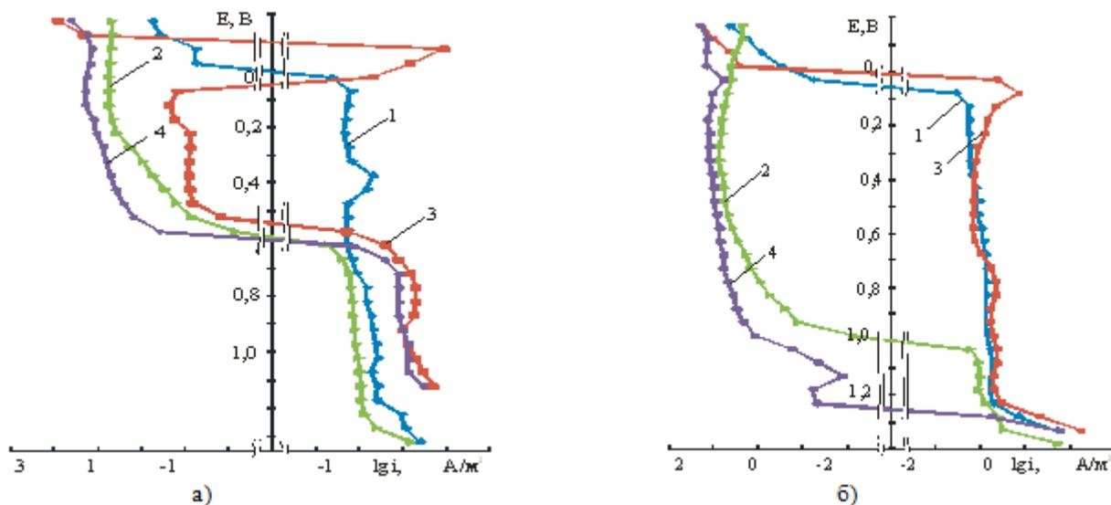
Рис. 2. Поляризационные кривые стали 12Х18Н10Т в реакционных массах синтеза бензотриазол-дикарбоновой кислоты при температурах: 1,2 – 20<sup>0</sup> С; 3,4 - 60<sup>0</sup> С; в присутствии катализаторов а) 0,2% FeSO<sub>4</sub>; б) 0,2% MnSO<sub>4</sub>. 1,3 –аэрированный, 2,4 – озонируемый растворы
