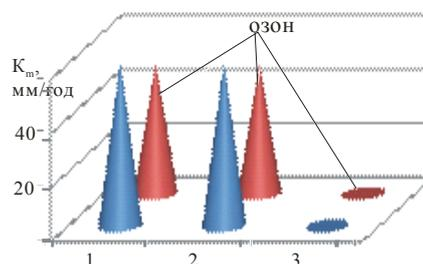
Рис. 1. Скорости коррозии  $K_m$  стали 12X18H10T,  $t=60^\circ\text{C}$ :
