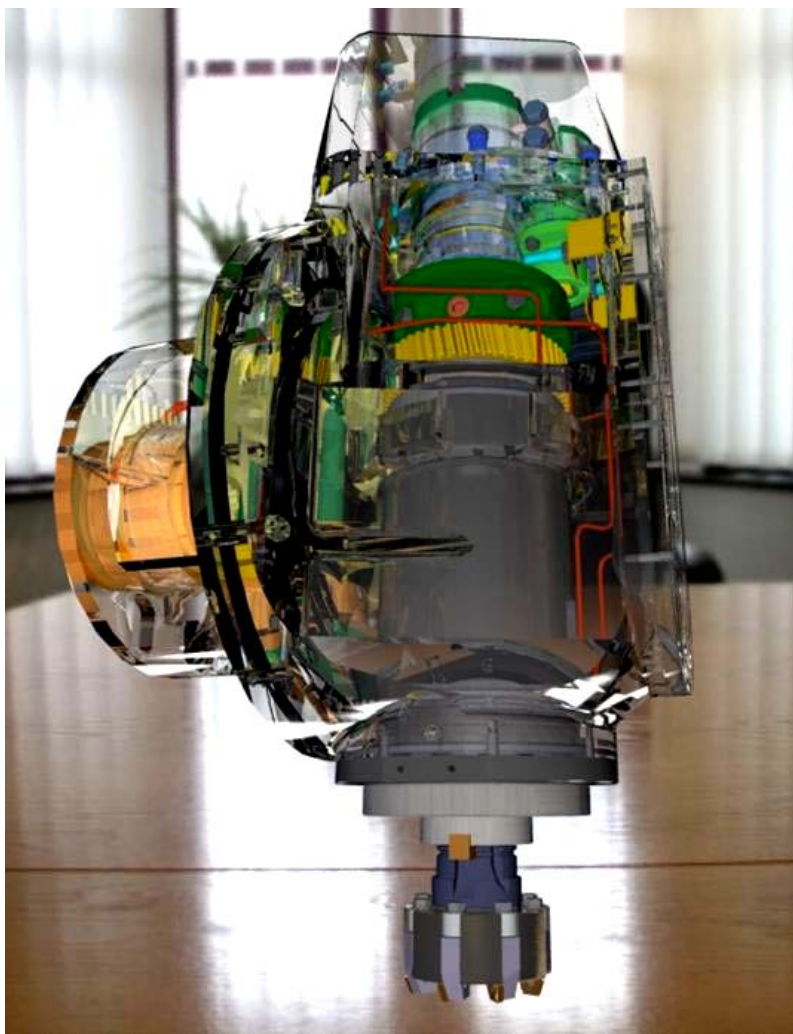
Рис. 2.19. Рендерінг шпиндельної бабки
