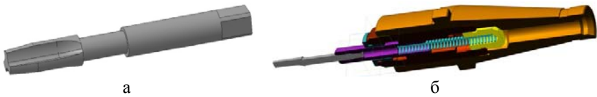
Рис. 5.13. Інструментальне оснащення для операції Різьблення: а – мітчик М10; б – інструментальний блок
