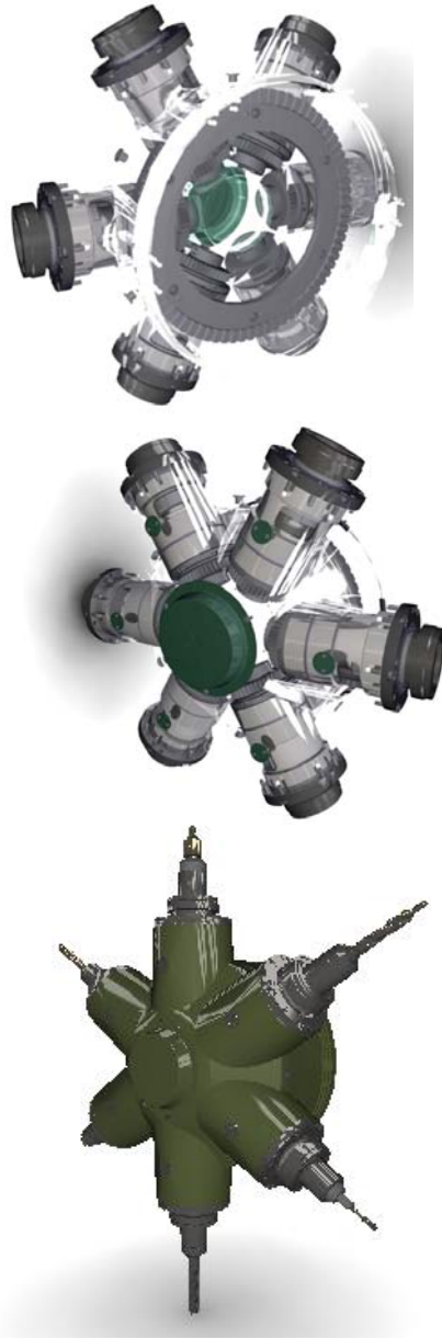
Рис. 3.15. Рендерінг 6-ти шпindelної револьверної головки
