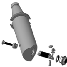
Рис. 5.17. Рознесення розточувального оправлення
