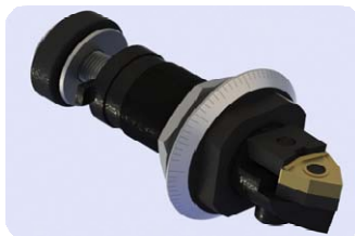
Рис. 5.16. Рендерінг: а – розточувальне оправлення; б – мікробор
