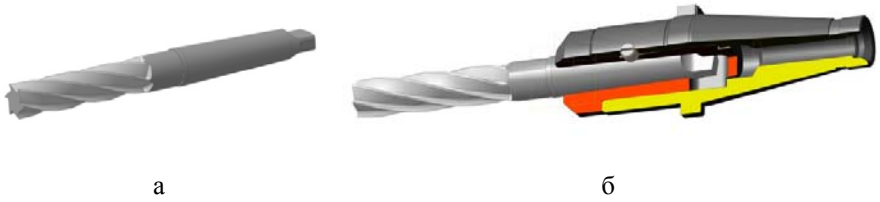
Рис. 5.10. Інструментальне оснащення для операції Розгортання: а – розгортка; б – інструментальний блок
