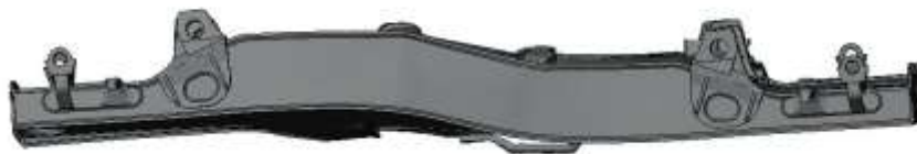
Рис. 6. Форма коливань, яка відповідає частоті 1,27 Гц
