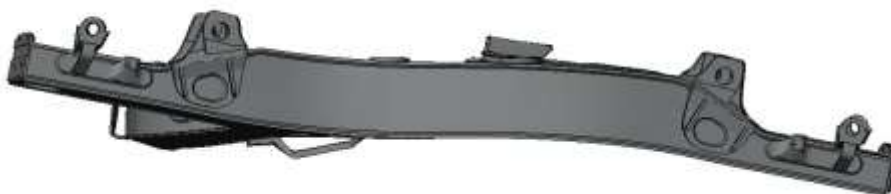
Рис. 8. Форма коливань, яка відповідає частоті 12,4 Гц
