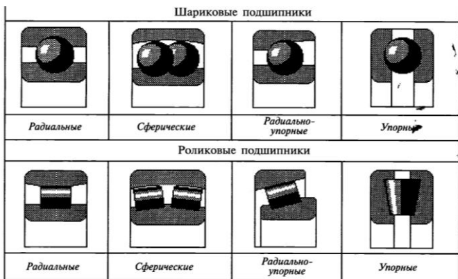
Рис. 1.1. Типы подшипников
