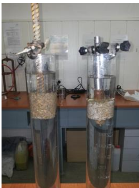
Рисунок 13 – Испытание ГГ в лабораторных условиях
