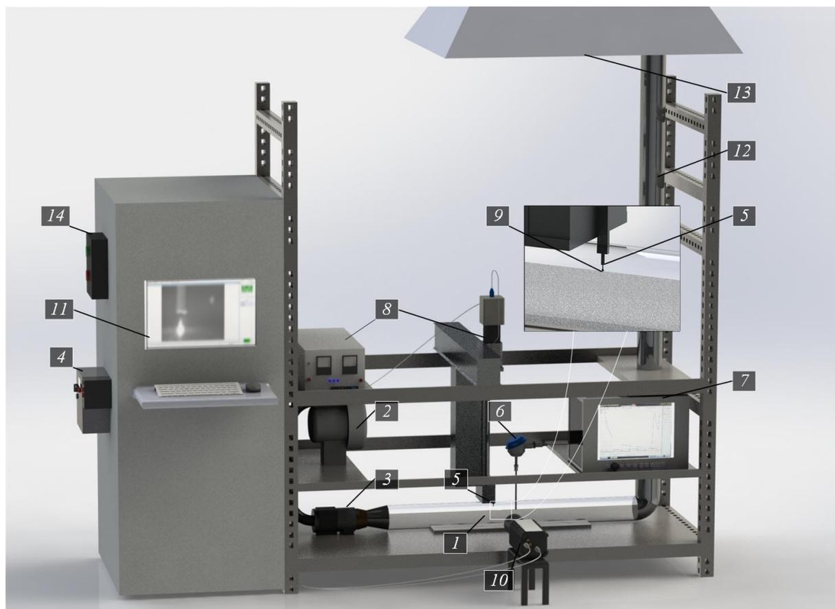
Рисунок 1.1 – Схема экспериментальной установки: 1 – кварцевый цилиндр; 2 – нагнетатель; 3 – воздухонагреватель; 4 – пульт управления нагревательной установкой; 5 – малоинерционная термопара; 6 – термопара; 7 – регистратор; 8 – координатный механизм; 9 – капля топлива; 10 – высокоскоростная камера; 11 – компьютер; 12 – воздухоотвод; 13 – вытяжка
