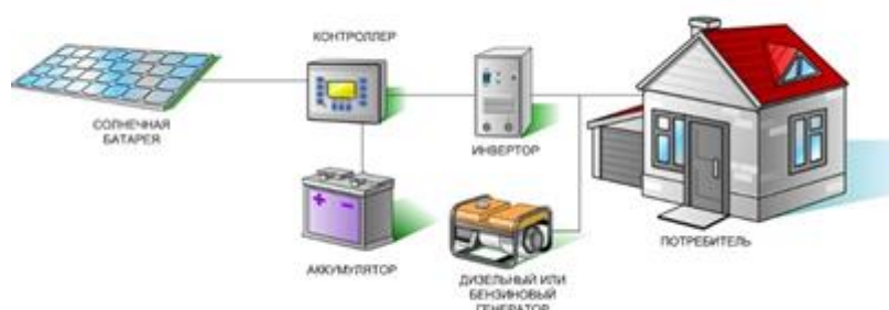
Рисунок 2. Структурная схема фотоэлектрической станции.
