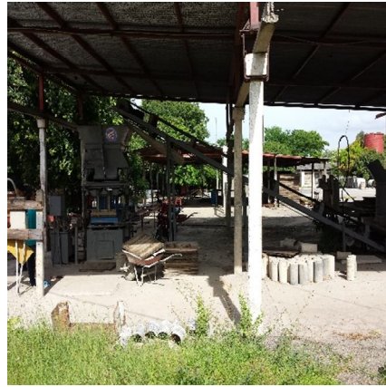
Foto 8. Máquina para elaborar bloques
