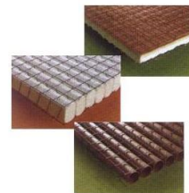
Material absorbente a base de espuma de poliuretano
