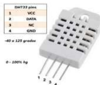
(Figura 5: configuración de los pines del sensor DHT22).
