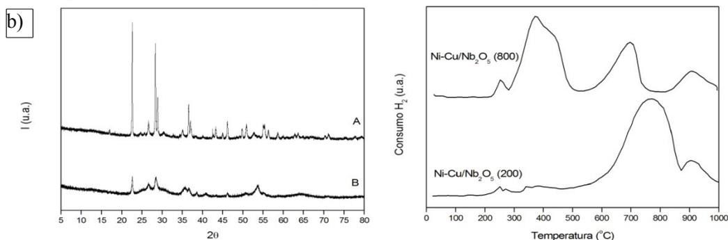
Figura 1. a) DRX de los catalizadores Ni-Cu/Nb<sub>2</sub>O<sub>5</sub> calcinados a 800°C (A) y a 200°C (B);  $\diamond$ Nb<sub>2</sub>O<sub>5</sub>,  $\Delta$ Nb<sub>1,33</sub>Ni<sub>0,67</sub>O<sub>4</sub>,  $\Theta$ Cu<sub>2</sub>O,  $\times$ NiO,  $*$ Nb<sub>2</sub>NiO<sub>6</sub>. b) Resultados del TPR para ambos catalizadores.
