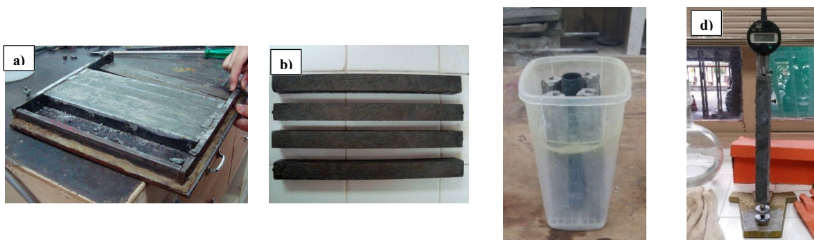
Figura 2 – Ensaio de RAA a) moldagem dos CPs b) CPs c) CPs submersos em água d) verificação da expansão
