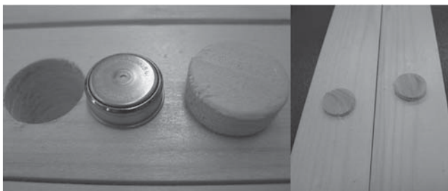
Slika 2: H-gumbek 23 za merjenje temperature in zračne vlažnosti ter njegova namestitve v vzorec.
