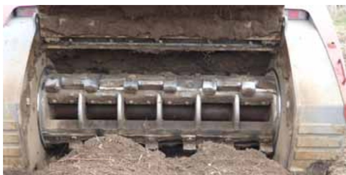
Priprava zemljišča s prekopalnikom ali gozdarskim mulčerjem
