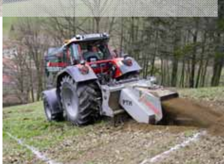
Priprava zemljišča s prekopalnikom ali gozdarskim mulčerjem
