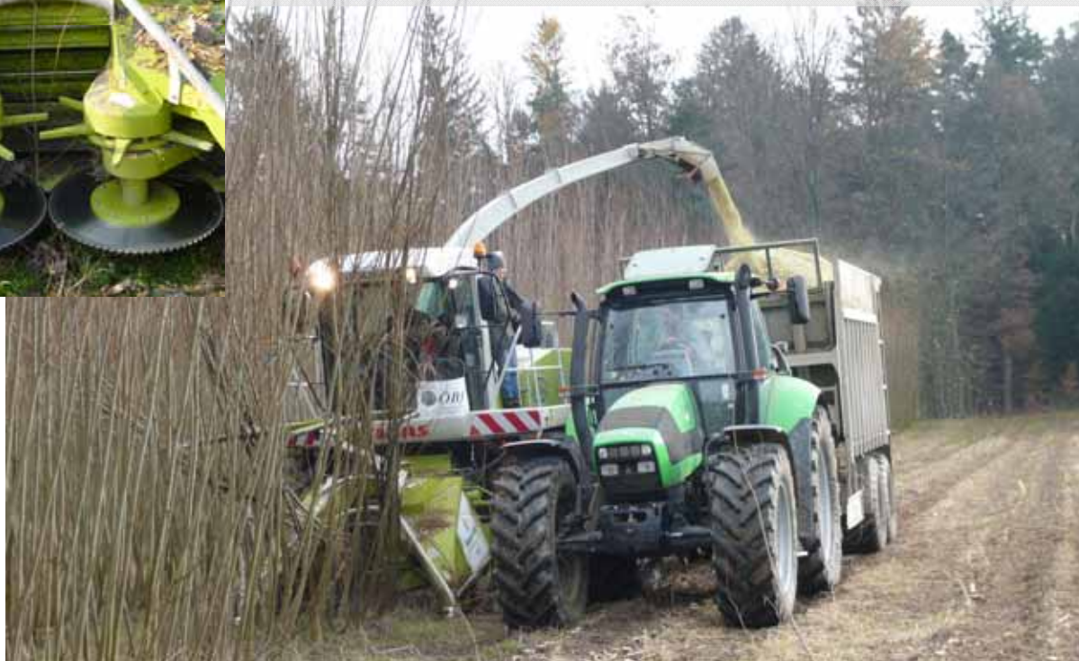
Sečnja in izdelava sekancev s prilagojenim samovoznim silažnim kombajnom z nameščenim žagalnim ustjem
